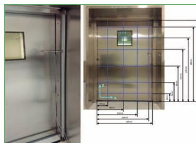
**Fig. 5:** Montaje del sistema de medida en el quirófono nº 10 y situación de los puntos de medida.
