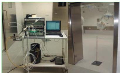
**Figura 3:** montaje de la técnica de gases trazadores en el bloque quirúrgico a estudio.
