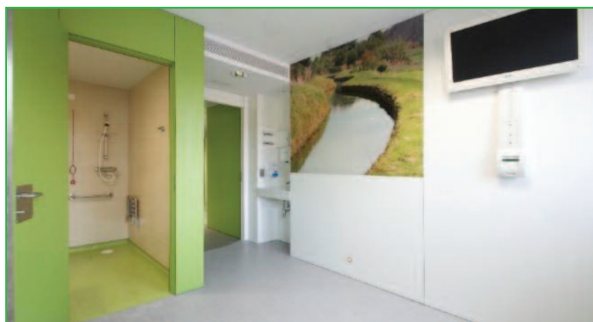
Foto 4. Habitación con visión del baño accesible desde la cama, pavimento continuo sin resaltes.
