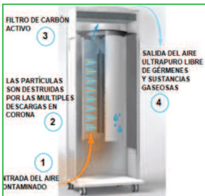
Figura 5. Dispositivo de plasma frío descarga en corona (cortesía de Genamo).
