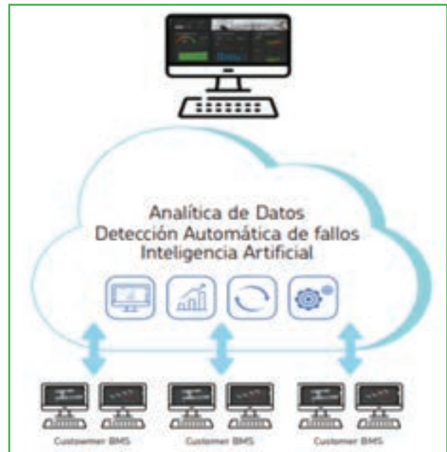
Figura 2. Conexión varios BMS a la nube.
